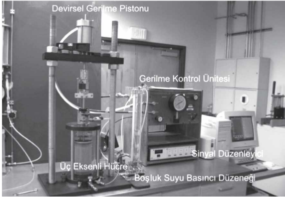
Şekil 3. Çalışmada kullanılan devirsel üç eksenli deney düzeneği.
